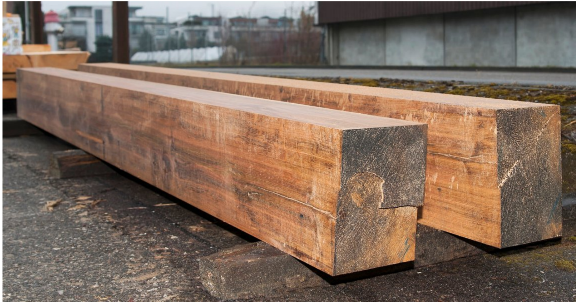
Rund drei Meter lang und 300 Kilo schwer: Die ersten Balken für den neuen Glockenstuhl der Kirche Amsoldingen sind zum Trocknen bereit.
